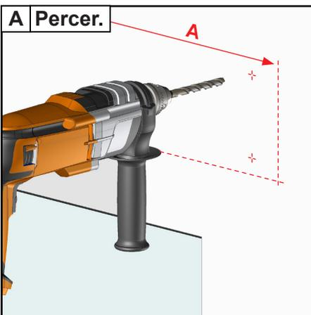
**Adapter la fixation à la nature du mur. Fixation avec des vis Ø8mm. Kit de vis et rondelles non fournis. Kit de scellement chimique, se référer aux instructions d'utilisation du produit utilisé.**
