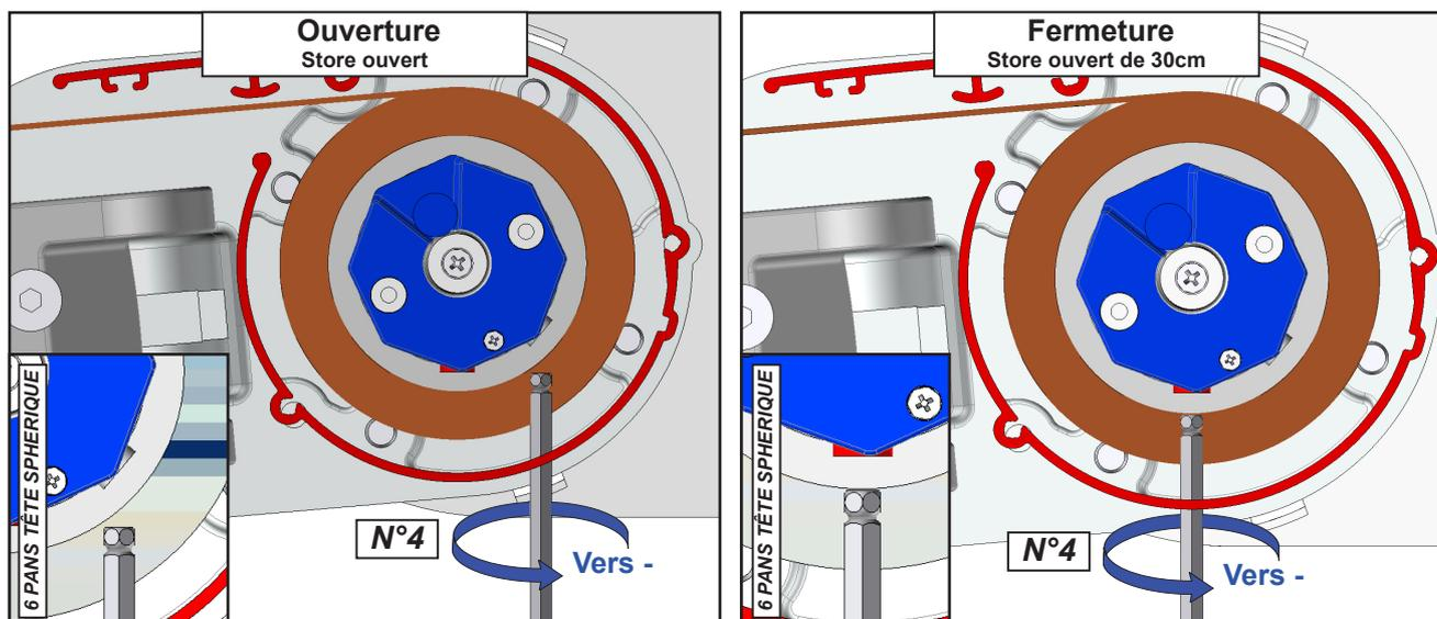
**Fin de course :** Actionner la vis vers le «+» pour plus de fermeture ou d'ouverture, vers le «-» pour moins fermeture ou d'ouverture. Réaliser un essai afin de valider la butée. Attention le moteur se mettra en protection thermique après 2 descente et 1 montée successives.
