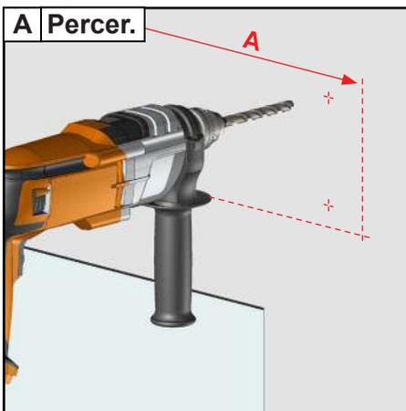
Adapter la fixation à la nature du mur. Fixation avec des vis Ø8mm. Kit de vis et rondelles non fournis.
