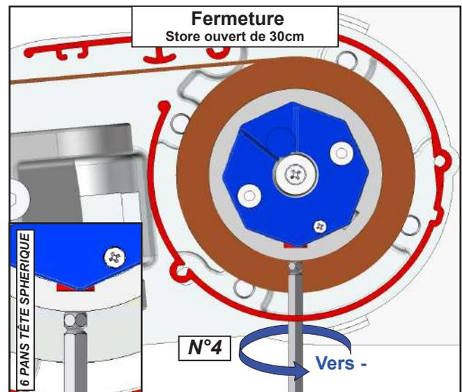
**Fin de course** : Actionner la vis vers le «+» pour plus de fermeture ou d'ouverture, vers le «-» pour moins de fermeture ou d'ouverture. Réaliser un essai afin de valider la butée. Attention le moteur se mettra en protection thermique après 2 descente et 1 montée successives.
